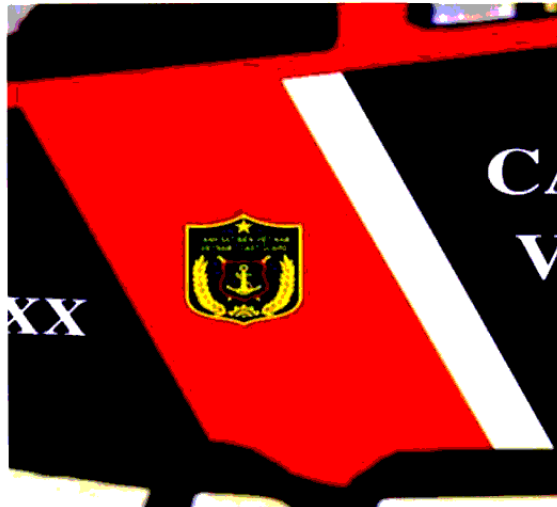
Vị trí cửa cabin khoang lái của máy bay (hai bên) sơn vạch dấu hiệu nhận biết và phù hiệu cảnh sát biển.
